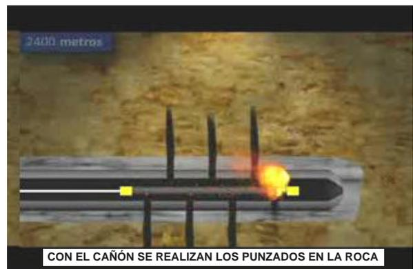
8º) A fin de poder conectar los poros en donde se encuentran alojados los hidrocarburos, es que provoca la denominada fractura hidráulica o “fracking”.
