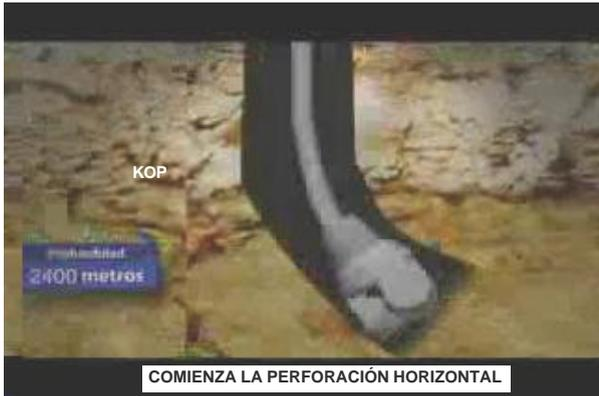
cambiar de vertical a horizontal y dirigida. A partir de este momento la perforación se dirige directamente a la roca de esquistos para atravesarla longitudinalmente.
